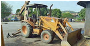
Backhoe loader/backhoe ditcher – untuk perparitan sahaja
